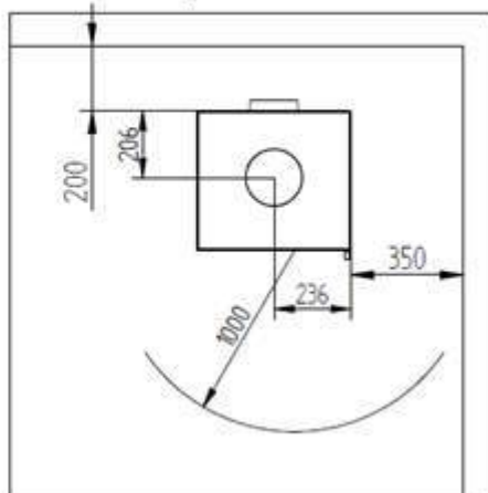
De afstand tot bandbare materialen ZONDER een geïsoleerd rookkanaal
