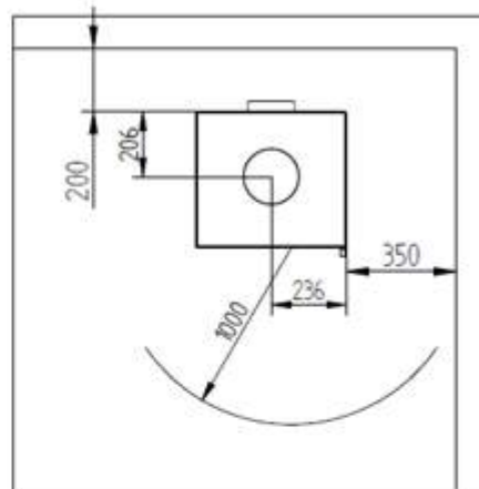
Abstand zu brennbarem Material OHNE isoliertem Rauchrohr
