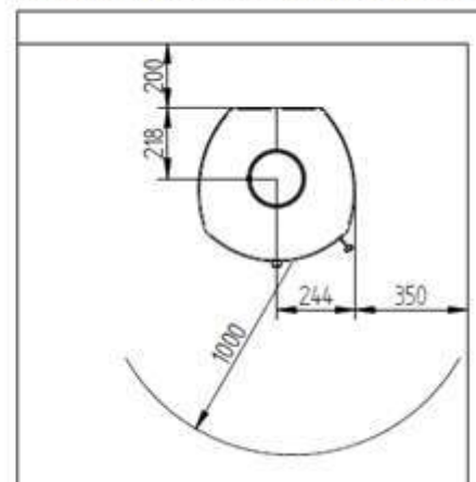
Avstånd til brännbar UTAN isolerad skorsten
