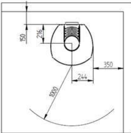
Avstånd til brännbar MED isolerad skorsten
