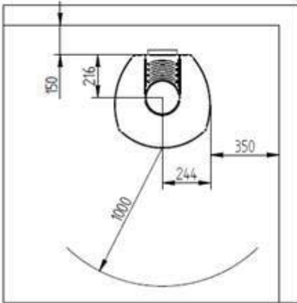
Afstand til brændbart MED isoleret røgrør
