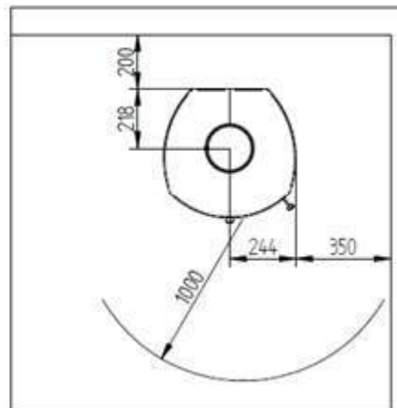
Afstand til brændbart UDEN isoleret røgrør
