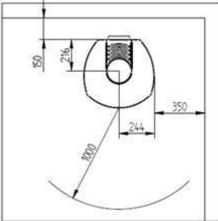
Avstand til brennbart MED isolerte røykrør
