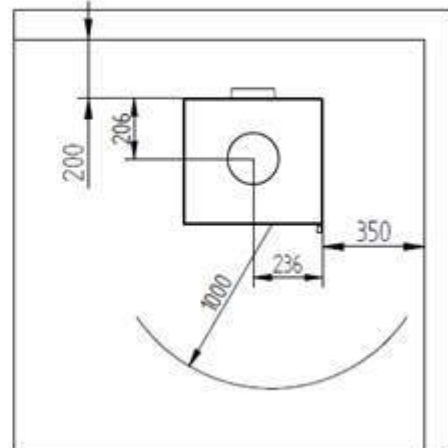
Distanza da materiali infiammabili SENZA canna fumaria isolata
