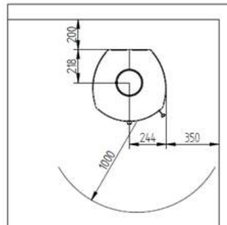
Avstand til brennbart UTEN isolerte røykrør
